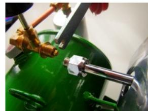
7.4 - Com a chave combinada solte o giclê entupido (sentido anti-horário), utilize a broca 2 mm que acompanha o equipamento, coloque-a no furo do giclê pela parte de trás, gire no sentido horário, retire a sujeira e em seguida passe um jato de ar.
