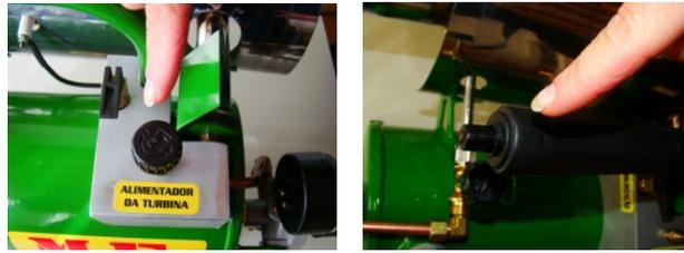
2.7 Se a turbina não entrar em funcionamento aumente a pressão no regulador para 3 kg repita a operação.
