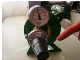
2.8 - Aqueça a turbina durante aproximadamente 1 minuto, assim que aquecer volte a pressão para 1,8 a 2kg no regulador e retire a ponteira de formiga.
