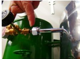
7.2 - Com uma chave de boca 13 mm solte os dois parafusos que fixam a turbina no chassi
