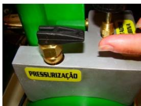
2.6 - Abra uma volta o registro de gás do alimentador da turbina (sentido anti-horário) e pressione simultaneamente o botão de ignição até que a turbina gere um estampido e entre em funcionamento.
