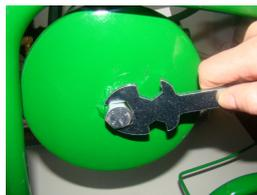
6.3 – Feche o reservatório e recarregue-o com óleo mineral para evitar a corrosão.
