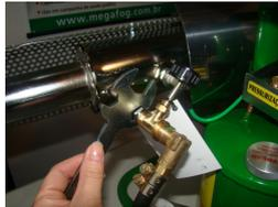
7.2 - Com a mesma chave combinada, segure firme e gire o injetor no sentido anti-horário removendo-o completamente.
