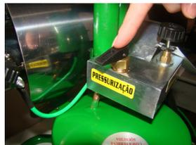
**2.4** – Conecte o abafador na turbina, abra o registro de gás do alimentador da turbina (sentido anti-horário), e pressione simultaneamente o botão de ignição até que a turbina entre em funcionamento.
