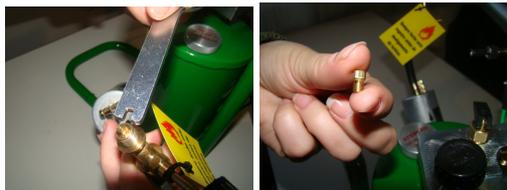
7.3 - Limpe o injetor com a broca de limpeza no sentido inverso do fluxo da calda.
