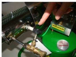
**3.1** – Deixe a turbina por aproximadamente 15 segundos ligada para que seque internamente fechando em seguida o registro alimentador de gás da turbina (sentido horário).
